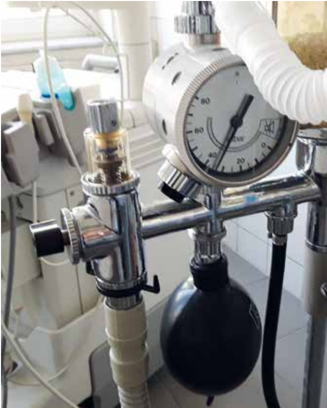
Foto 2: APL ventil je obrnjen v levo, kar pomeni, da je sistem popolnoma zaprt in vsi plini ostajajo znotraj. Nastavitev največjega dovoljenega tlaka v tem primeru ne deluje – tlak narašča preko omejitev, ki smo jih določili. Takšna nastavitev lahko zelo hitro privede do smrti pacienta. (Foto: Jerneja Sredenšek)
