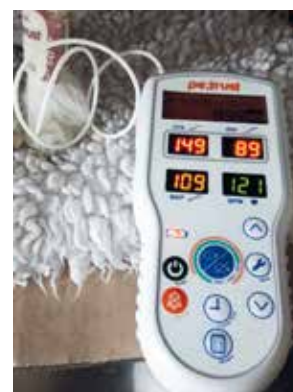
Foto 4: Primer veterinarskega prenosnega oscilometričnega aparata za merjenje krvnega tlaka. (Foto: Jerneja Sredenšek)
